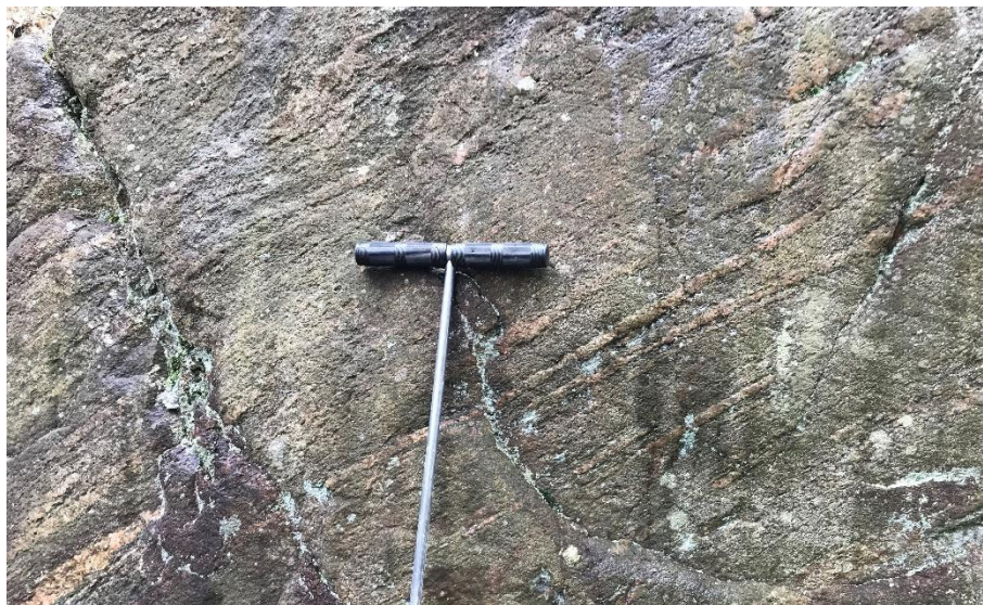
Figur 3.1. Befintliga bergarter: ådergnejs med foliationslutning mot väst (vänster i bild). Bild tagen mot norr.
